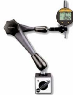
ψηφιακό μετρητικό ρολοί σε αρθρωτή διάταξη με μαγνητική συγκράτηση
